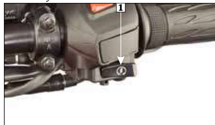
(1) Interruptor de arranque eléctrico
