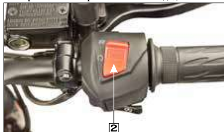
(2) Interruptor parada del motor
