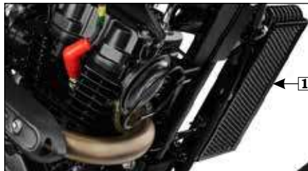
(1) Radiador de aceite de motor
