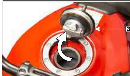
(3) Tapa tanque de combustible
