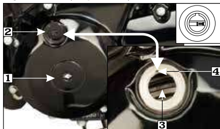
(1) Tapa orificio del cigüeñal (2) Tapa orificio de distribución (3) Marca 'T' (4) Marca índice
