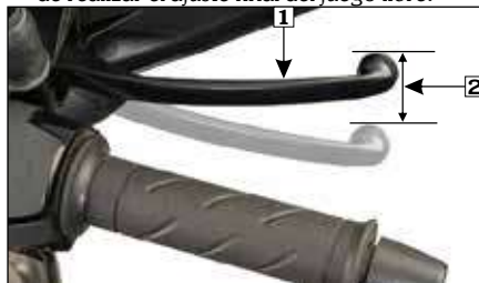
(1) Palanca freno delantero (2) Juego libre 10-20 mm
